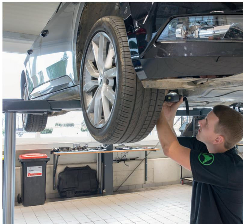
Gesamtspur vorne und hinten sowie die Sturzwerte aller 4 Räder analysieren. Dadurch kann einer ungleichmäßigen Reifenabnutzung und frühzeitigem Reifenverschleiß effektiv entgegengewirkt werden.
