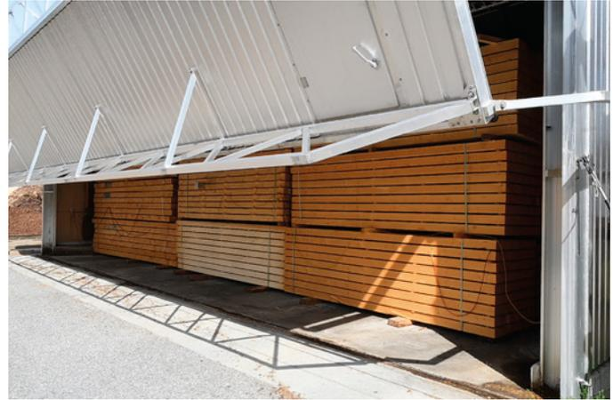
Technische Trocknung von **MH<sup>®</sup>-MassivHolz** durch vollautomatische und computergesteuerte Trockenkammern
