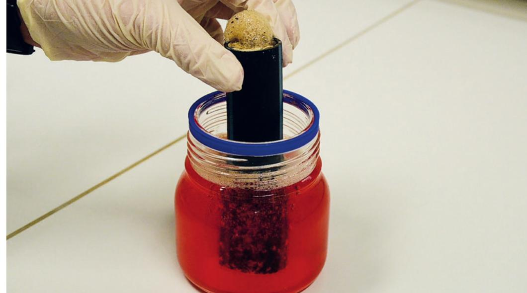
Entkalkung eines Wärmetauschers
