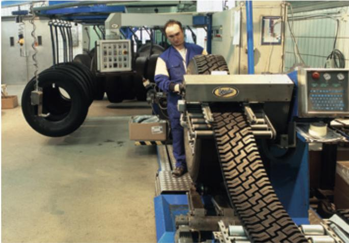
Bindegummi wird auf die Karkasse aufgespritzt und die vulkanisierte, profilierte Lauffläche computergesteuert spannungsfrei aufgebracht.
