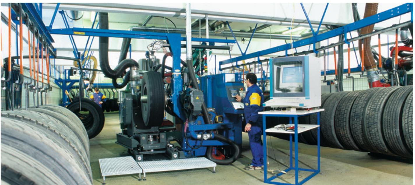
*Computergesteuerte und mit Laser ausgestattete Raumaschinen vermessen die Geometrie der Reifen, sichern eine
