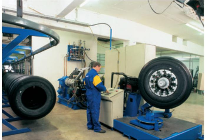
Bei der Heißrunderneuerung werden unvulkanisierte Kautschukmischungen in Neureifen-Qualität präzise extrudiert und auf die Karkasse aufgebracht.
