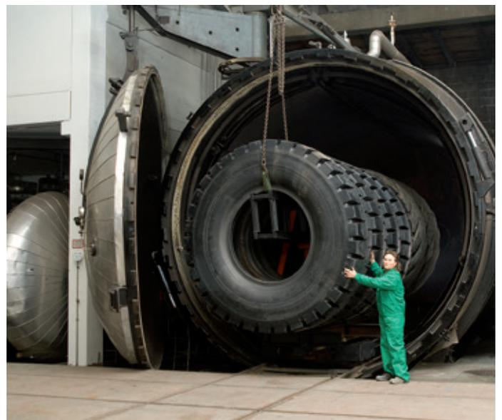
*In der EM-Runderneuerungsabteilung stehen Produktionsanlagen für Reifen bis 5 m Durchmesser zur Verfügung.*
