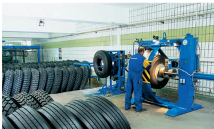
Alle Reifen werden nach der Vulkanisation einer Druckprüfung unterzogen.
