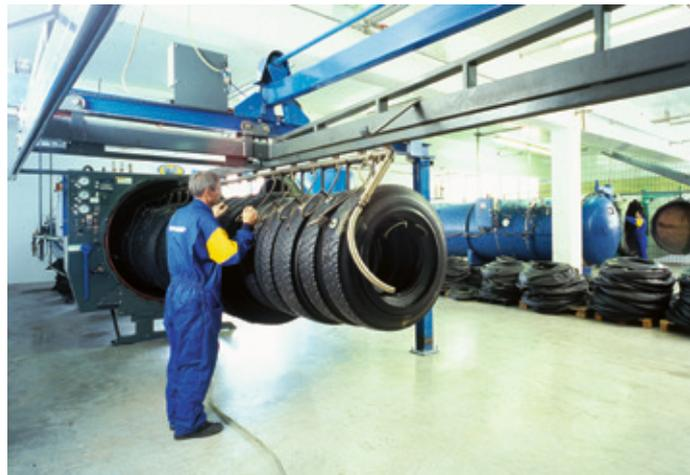
Elastische Gummihüllen umschließen den Reifen während des Vulkanisationsvorganges. Die Vulkanisation erfolgt unter Druck bei 99 °C mit automatischer Heizzeitberechnung.
