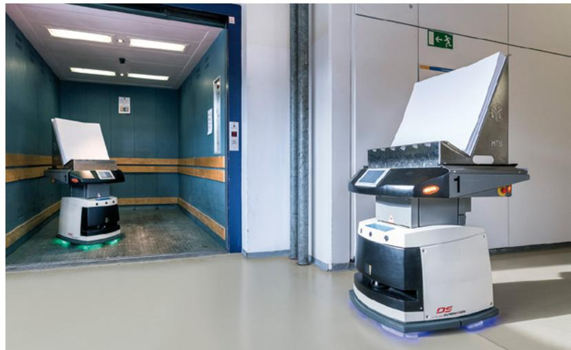
*Flexibel angepasste Kleinlast-Fahrzeuge vom Typ SALLY nutzen dieselben Gänge und Aufzüge wie die menschlichen Kollegen, die sie entlasten und dadurch ihre Produktivität steigern.*
