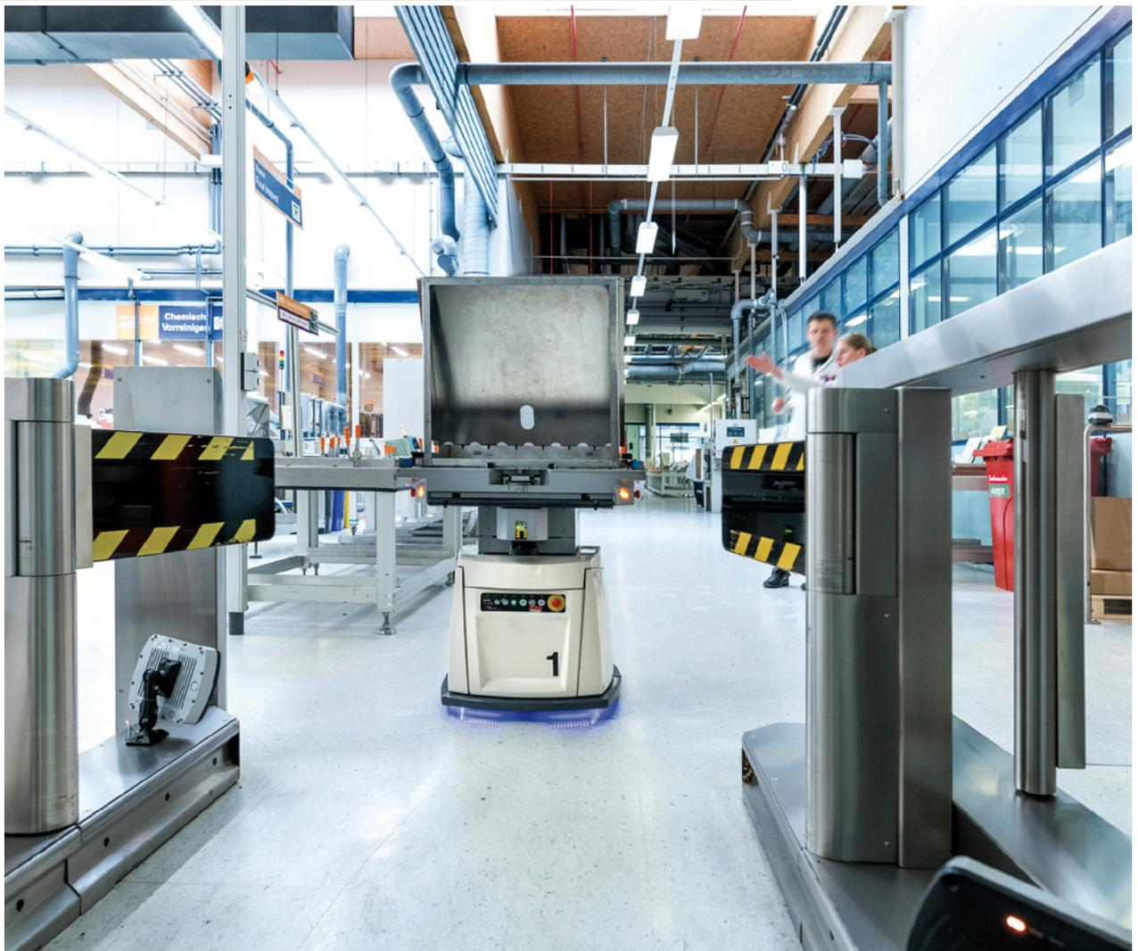
*Der kleinste Roboter aus dem Haus DS AUTOMOTION ist seit 2016 am Markt erhältlich. Seitdem transportiert SALLY Lasten bis zu 100 kg und unterstützt Menschen in vielen Bereichen.*
