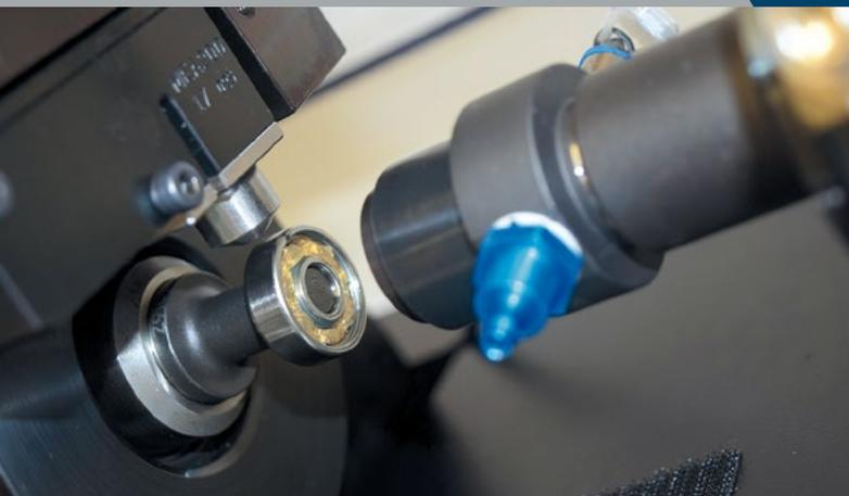
Geräuschprüfstand für Wälzlager
