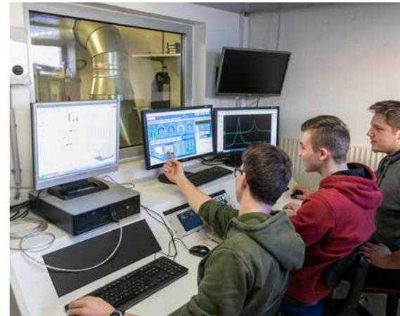
Moderne Verbrennungsmotoren werden permanent in Bezug auf niedrigen Kraftstoffverbrauch und geringe Abgasemissionen optimiert. Diese Abstimmung, auch Applikation genannt, erfolgt in der Regel auf einem Motorenprüfstand an einem Versuchsmotor. Mithilfe entsprechender Software können verbrauchs- und emissionsrelevante Betriebsparameter, beispielsweise Zündzeitpunkt oder Einspritzmenge, gemessen und verändert bzw. optimiert werden.
