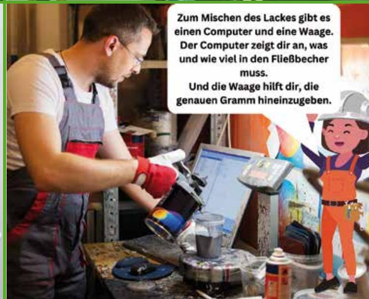
Zum Mischen des Lackes gibt es einen Computer und eine Waage. Der Computer zeigt dir an, was und wie viel in den Fließbecher muss. Und die Waage hilft dir, die genauen Gramm hineinzugeben.
