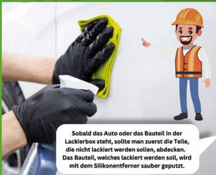
Sobald das Auto oder das Bauteil in der Lackierbox steht, sollte man zuerst die Teile, die nicht lackiert werden sollen, abdecken. Das Bauteil, welches lackiert werden soll, wird mit dem Silikonentferner sauber geputzt.
